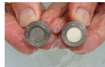
LAE HAE Piezometer Filters
