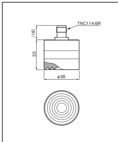
水道管からの漏水音の聴音用
